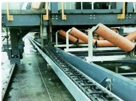
Le catene portacavi impiegate sempre più nel campo dell'automazione civile ed industriale (manipolatori, robot, carri ponte, ecc.) vengono oggi fabbricate per la maggior parte in materiali plastici (PVC, ABS, ecc.), per cui è importante effettuare un collaudo significativo per evidenziarne i difetti di stampaggio prima di collocarle sul mercato.
